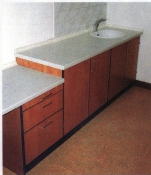
Steh- und Sitzarbeitsplatz – Kombination mit seitlichem Höhenversprung von 760 mm auf 900 mm
